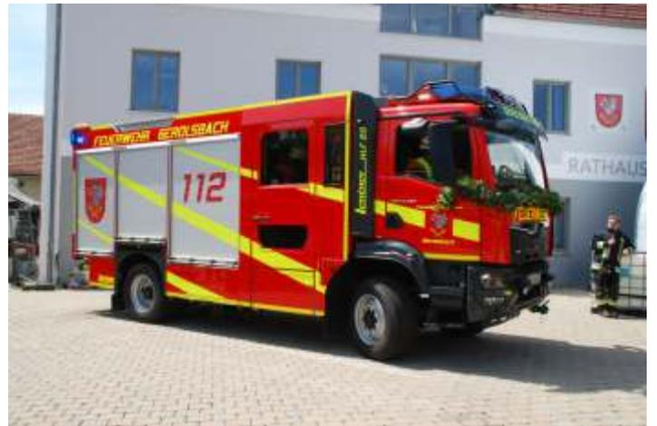
Das neue HLF 20 ersetzt das über 30 Jahre alte LF16/12 und bietet mit einem 2000 Liter großen Löschwassertank und 120 Litern Schaummittel eine deutliche Verbesserung der Einsatzkapazitäten. Die Feuerwehr Gerolsbach freut sich, mit diesem hochmodernen Fahrzeug, das von der renommierten Firma Lentner auf einem MAN-Fahrgestell aufgebaut wurde, nun noch besser auf Brände, Verkehrsunfälle und technische Hilfeleistungen reagieren zu können.
